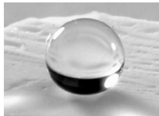
Fot. 1 – Kropla wody na powierzchni zmodyfikowanej hydrofobowo
